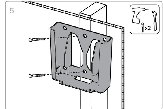
À l'aide du support mural et d'un niveau à bulle, tracez des repères sur le mur.
