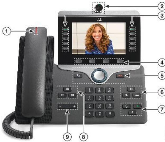
Rysunek 7: Przyciski i podzespoły telefonu IP Cisco 8845
