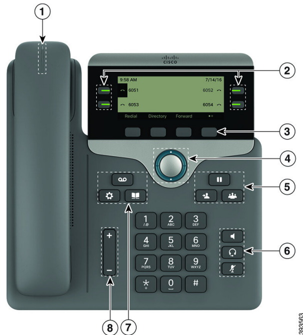
Rysunek 6: Telefon IP Cisco z serii 7800 — przyciski i funkcje
