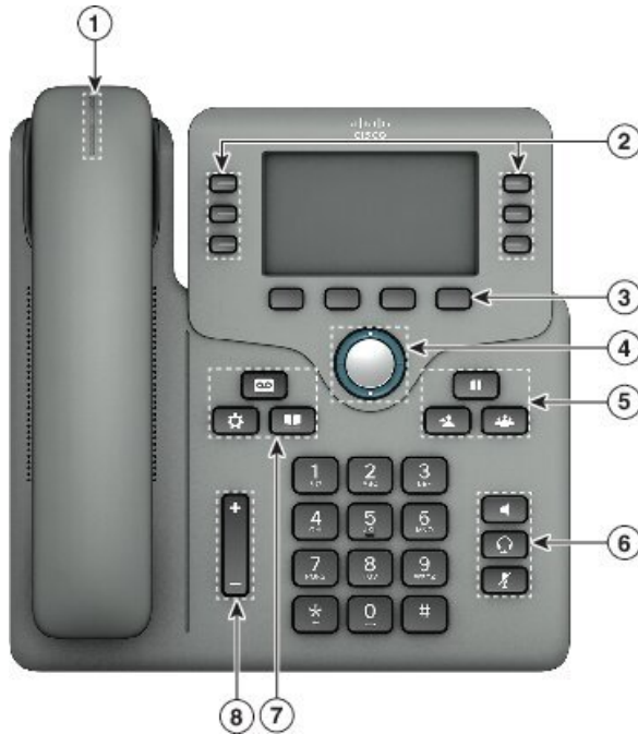
Rysunek 5: Wieloplatformowe telefony IP Cisco 6871 Przyciski i funkcje
