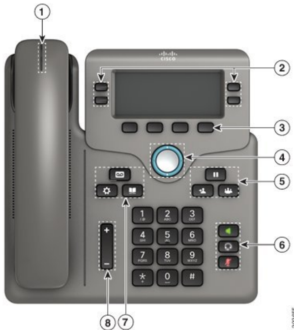
Rysunek 4: Przyciski i funkcje wieloplatformowych telefonów IP Cisco 6841, 6851 oraz 6861
