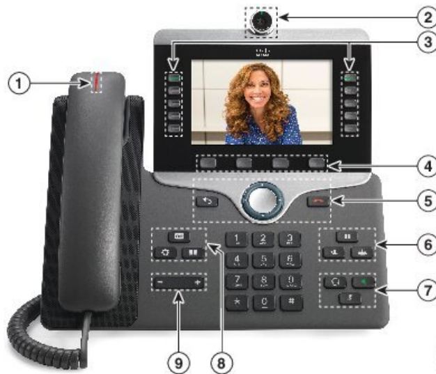
Figura 7: Botones y hardware del teléfono IP 8845 de Cisco
