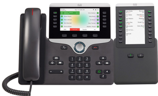
Figura 10: Módulo de expansión de teclas del teléfono IP 8851/8861 de Cisco con pantalla doble
