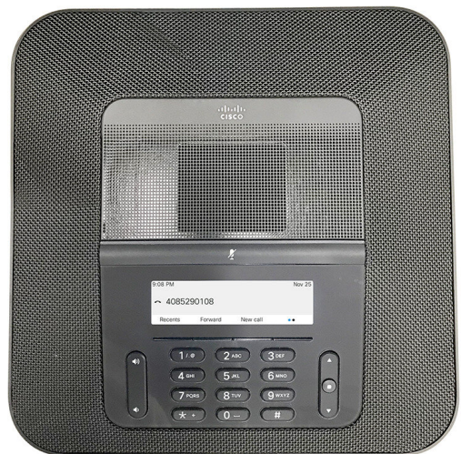
Rysunek 2: Telefon konferencyjny IP Cisco 8832 z wieloplatformowym oprogramowaniem sprzętowym
