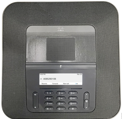
Rysunek 1: Telefon konferencyjny IP Cisco 8832 z wieloplatformowym oprogramowaniem sprzętowym
