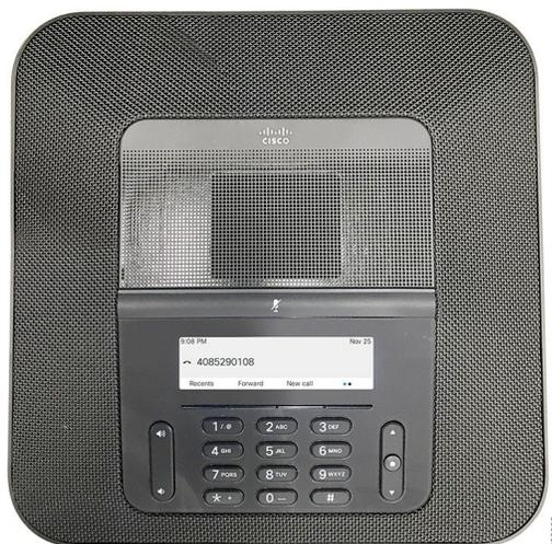
El teléfono para conferencias tiene micrófonos sensibles con una cobertura de 360 grados. Esta cobertura le permite hablar con una voz normal y ser oído claramente a una distancia de hasta 10 pies (3 m). El teléfono también incluye una tecnología resistente a interferencias de teléfonos móviles y otros dispositivos inalámbricos, lo que garantiza comunicaciones claras sin distracciones. El teléfono proporciona una pantalla color y botones
