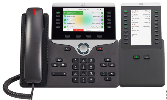
Figur 5. Expansionsmodul med enkel LCD-skärm
