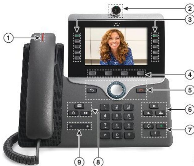
Figur 1. Cisco IP-telefon 8845, knappar och maskinvara
