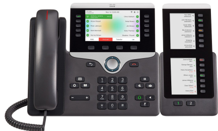
Figur 6: Tastudvidelsesmodul Cisco IP-telefon 8851/8861 med to skærme
