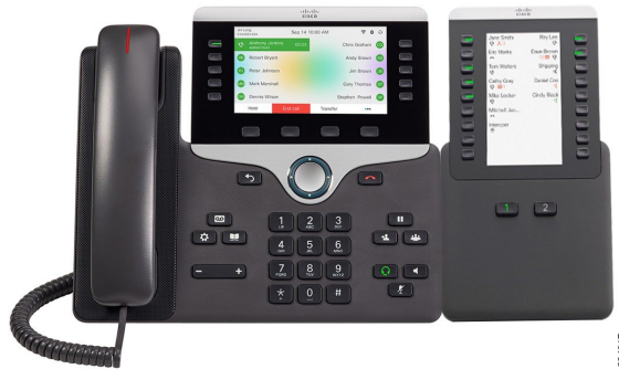
Figur 6: Tastudvidelsesmodul Cisco IP-telefon 8851/8861 med to skærme
