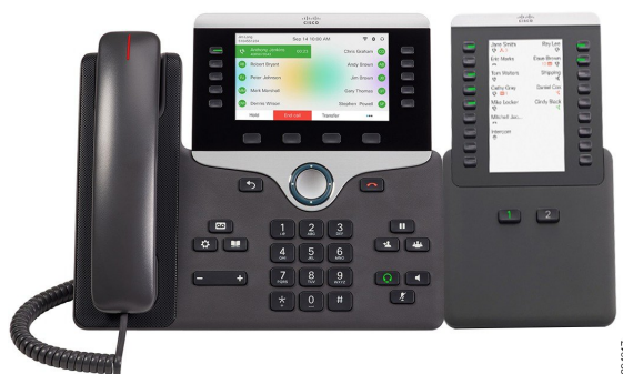
Figur 4. Expansionsmodul med enkel LCD-skärm
