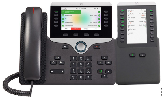
그림 4: 키 확장 모듈(단일 LCD 화면 사용)
