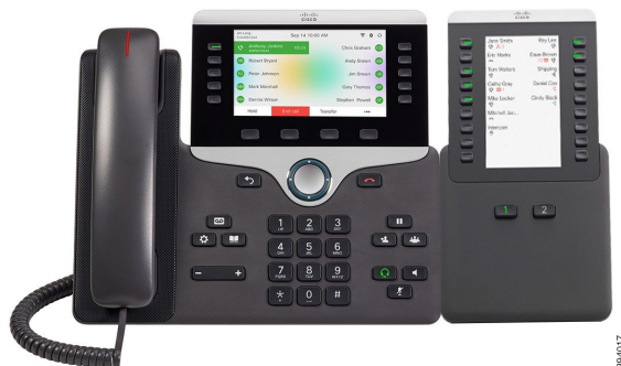
Abbildung 4: Erweiterungsmodul mit einem LCD-Bildschirm
