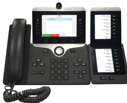
Abbildung 6: Cisco IP Phone 8865-Erweiterungsmodul mit zwei Bildschirmen
