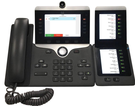
Figur 6: Tastudvidelsesmodul til Cisco IP Phone 8865 med to skærme
