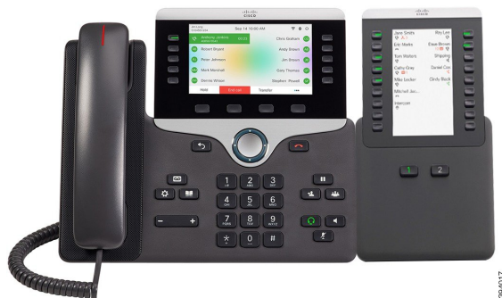
Figur 4: Tastudvidelsesmodulet med enkelt LCD-skærm
