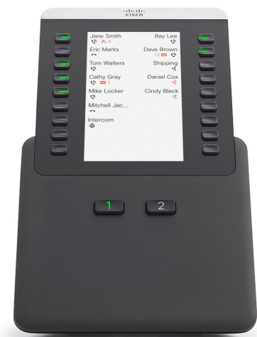
Rysunek 17: Moduł rozbudowy klawiatury do telefonów Cisco IP Phone z serii 8800
