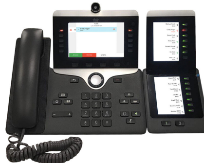
Rysunek 12: Moduł rozbudowy klawiatury telefonu IP Cisco 8865 z dwoma ekranami
