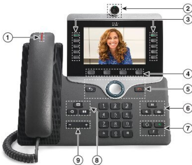
Figur 2: Knapper og maskinvare på Cisco IP-telefon 8845
