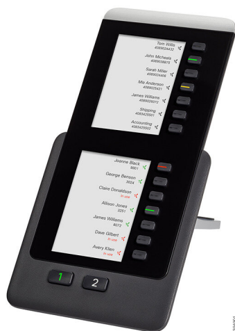
Σχήμα 15: Μονάδα επέκτασης πλήκτρων για το Τηλέφωνο IP Cisco 8851/8861
