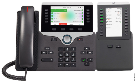
Σχήμα 11: Μονάδα επέκτασης πλήκτρων Cisco IP Τηλεφώνου 8851/8861 με διπλή οθόνη
