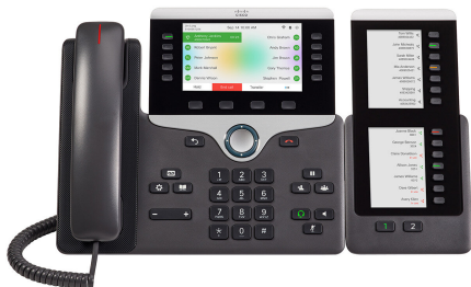
Σχήμα 11: Μονάδα επέκτασης πλήκτρων Cisco IP Τηλεφώνου 8851/8861 με διπλή οθόνη
