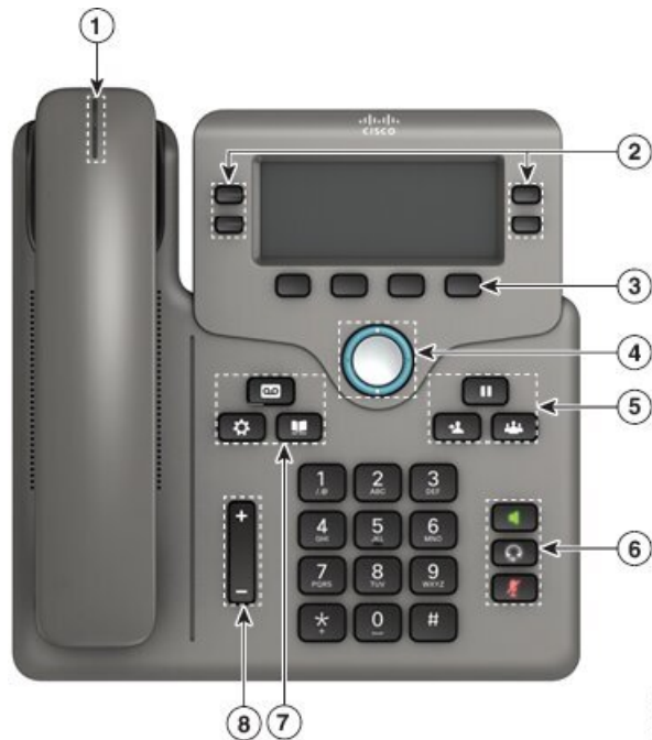
Мал. 3: Функції й кнопки багатоплатформових IP-телефонів Cisco 6841, 6851 і 6861
