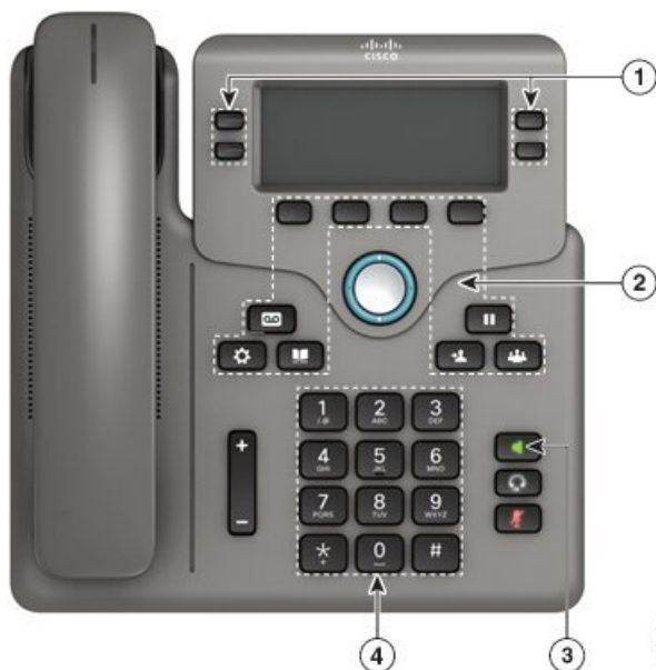
Slika 13: Funkcije za dostopnost za gibalno ovirane – prikazan je Telefoni Cisco IP Phone 6841 za več platform
