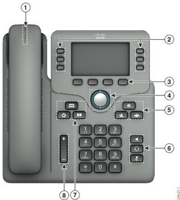
Obrázok 4: Multiplatformové telefóny IP Cisco 6871 Tlačidlá a funkcie
