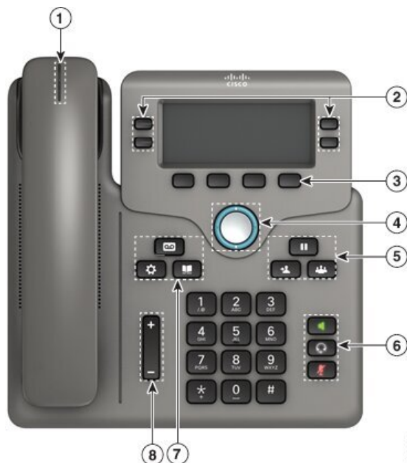
Obrázok 3: Tlačidlá a funkcie multiplatformových telefónov IP Cisco 6841, 6851 a 6861
