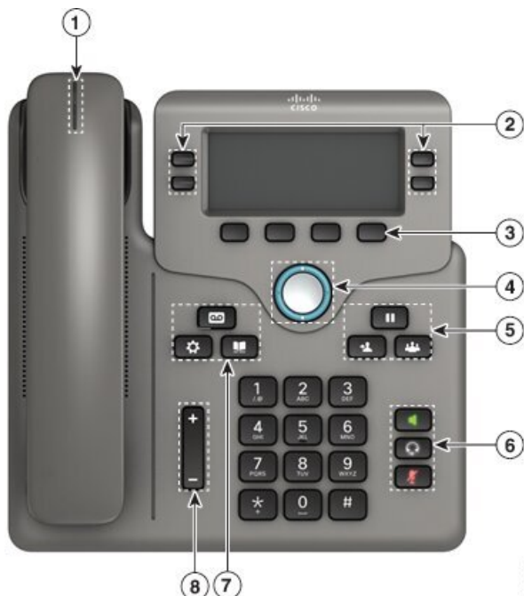
Figura 3: Botones y características de los Teléfonos multiplataforma IP de Cisco serie 6841, 6851 y 6861
