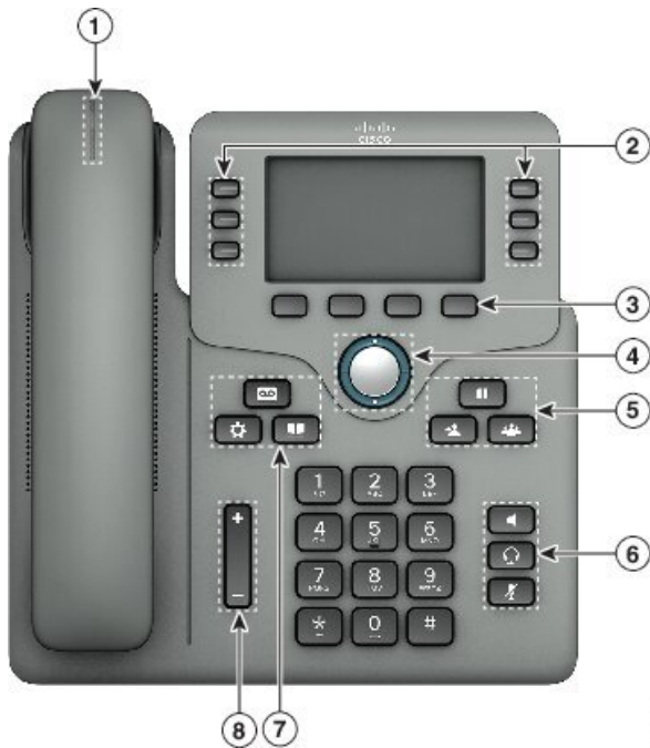
Figura 4: Teléfonos multiplataforma IP Cisco 6871 Botones y funciones
