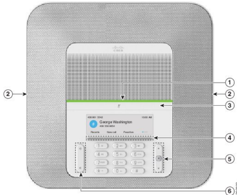
Illustration 11 : Boutons et fonctionnalités des téléphones de conférence IP Cisco 8832
