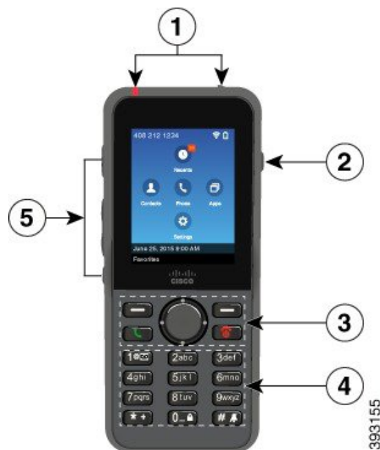
Illustration 2 : Boutons et matériel du Téléphone IP sans fil Cisco 8821
