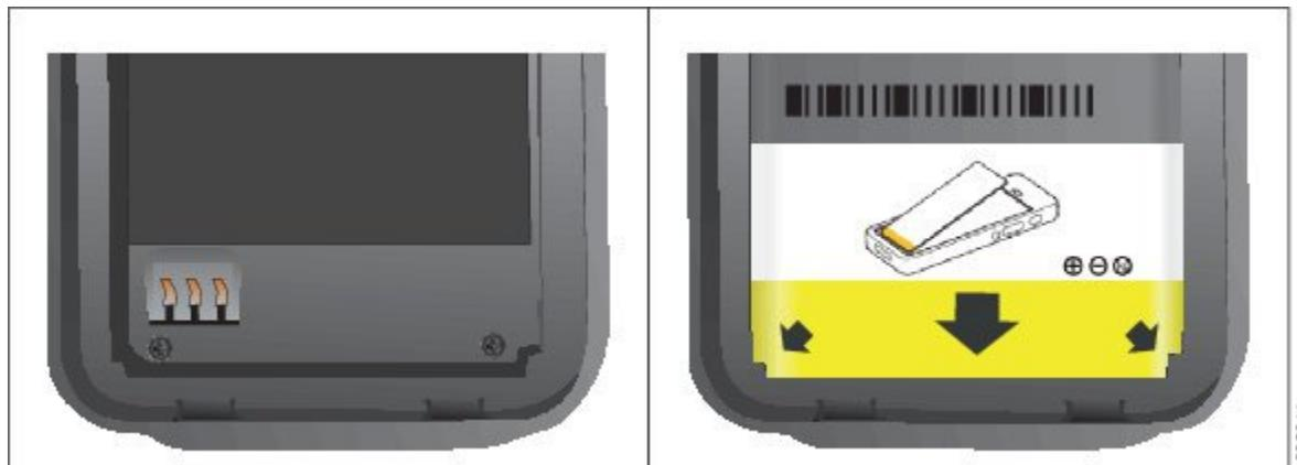
(a) أمسـكـ الـبـطـارـيـةـ بـحـيـثـ تـكـونـ الـحـافـةـ السـفـلـيـةـ قـرـيبـةـ مـنـ الـجـزـءـ السـفـلـيـ لـلـحـجـيرـةـ.ـ تـأـكـدـ أـنـ الـمـوـصـلـاتـ المـعـدـنـيـةـ المـوـجـودـةـ بـالـهـاـفـ وـبـالـبـطـارـيـةـ تـواـجـهـ بـعـضـهـ بـعـضـ.ـ فـيـ الـبـطـارـيـةـ،ـ يـجـبـ أـنـ يـكـونـ شـعـارـ Ciscoـ قـرـيبـاـ مـنـ مـزـلاـجـ القـفلـ وـيـجـبـ أـنـ يـشـيرـ السـهـمـ إـلـىـ قـاعـدـةـ الـهـاـفـ.
