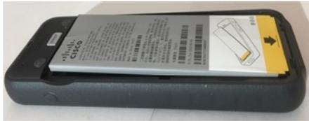
На представленому рисунку показано той самий роздутий акумулятор під час установлення кришки. Зверніть увагу, що середина кришки вигнута. Існують складнощі під час з'єднання фіксаторів у середині кришки.
