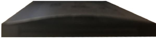
La siguiente imagen muestra una batería hinchada en el compartimento de la batería. Fíjese que la batería no está al ras de las paredes del compartimento alrededor del perímetro de la batería.
