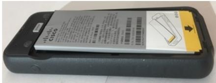
La siguiente imagen muestra la misma batería hinchada cuando se pone la cubierta. Fíjese que la parte central de la cubierta está arqueada. Los cierres en la mitad de la cubierta no se acoplan fácilmente.
