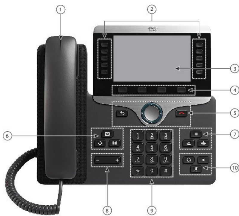
Fig. 7. Caracteristici de accesibilitate pentru persoane cu deficiențe de vedere sau nevăzători - Telefonul Cisco IP prezentat
