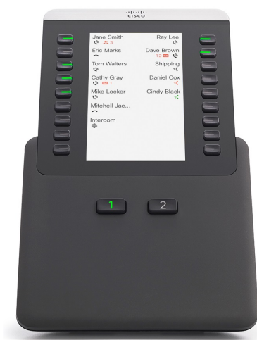
Attēls 30: Taustiņa paplašinājuma modulis ar divām kolonnām
