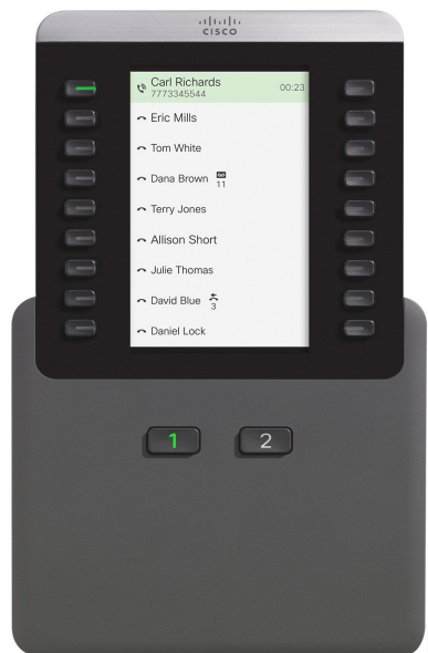
Attēls 29: Taustiņu paplašinājuma modulis ar vienu kolonnu
