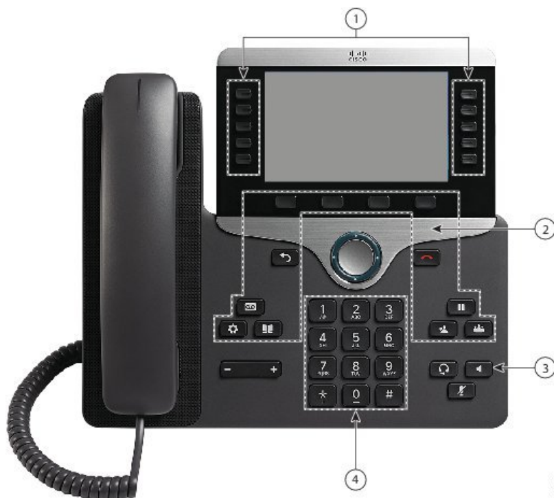
ábra 8: Mozgássérült kiegészítő lehetőségek—Cisco 8861-es IP-telefon bemutató
