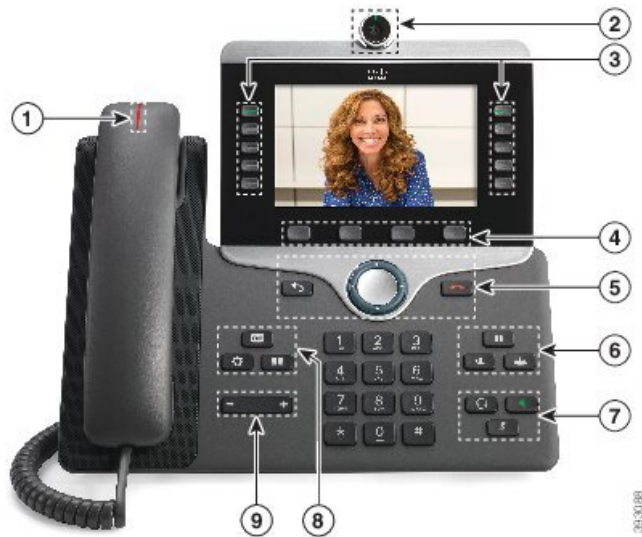
ábra 3: A Cisco 8845-ös IP-telefon gombjai és felépítése
