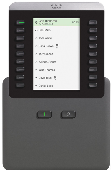
ábra 29: Kulcskiterjesztő modul egy oszloppal
