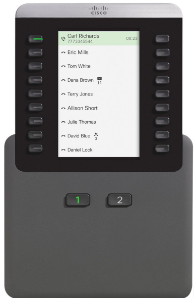
Kuva 29. Näppäinlaajennus yhden sarakkeen tilassa
