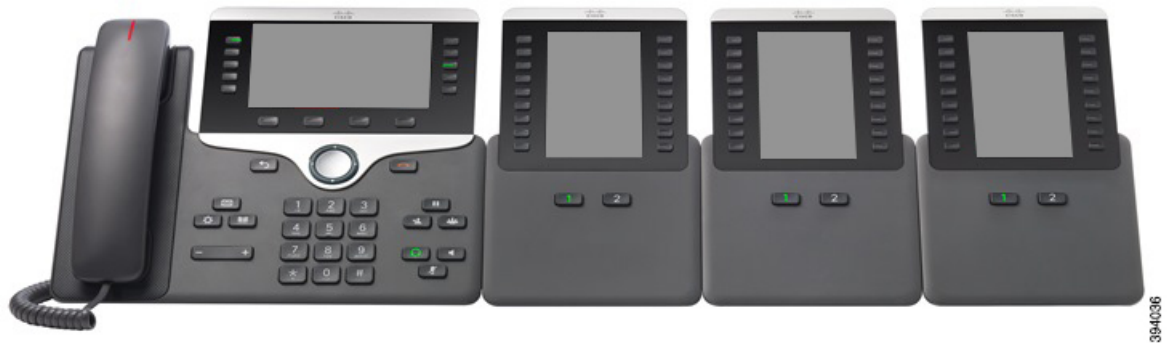
Σχήμα 27: Cisco IP Τηλέφωνο 8865 με τρεις μονάδες επέκτασης πλήκτρων για το Cisco IP Τηλέφωνο 8865
