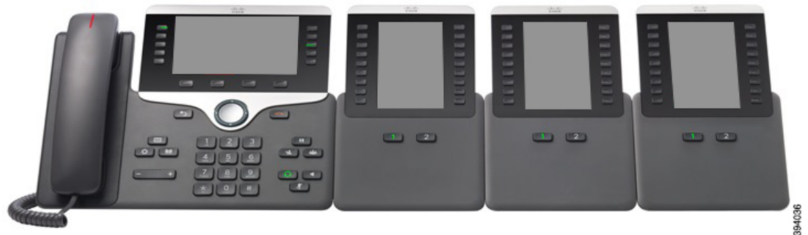
Фигура 26: Cisco IP телефон 8861 с три разширителни модула с клавиши на Cisco IP телефон 8800
