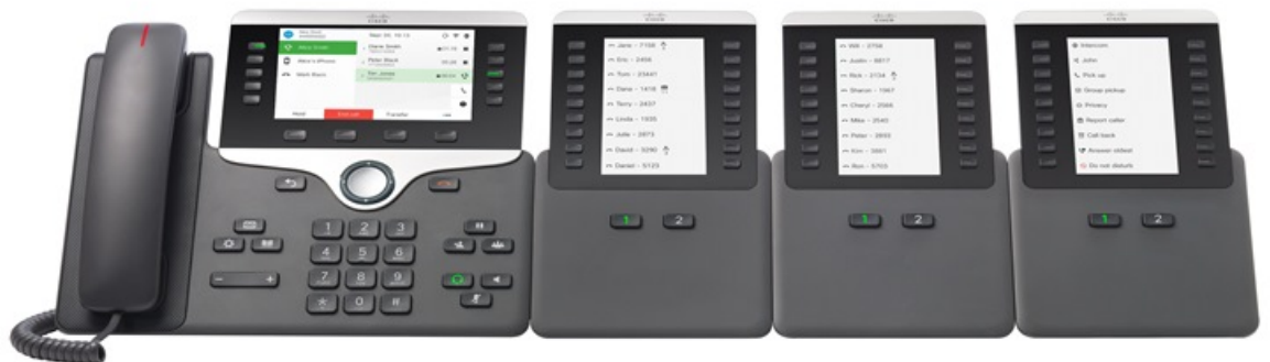
รูปที่ 18: โทรศัพท์ IP ของ Cisco รุ่น 8861 ที่มีโมดูลส่วนขยายคีย์ของโทรศัพท์ IP ของ Cisco ซีรีส์ 8800 สามชุด
