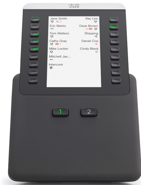
Kuva 21. Cisco IP -puhelimen 8800 näppäinlaajennus kaksisarakeisessa tilassa
