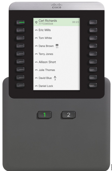
Kuva 20. Cisco IP -puhelimen 8800 näppäinlaajennus yksisarakeisessa tilassa
