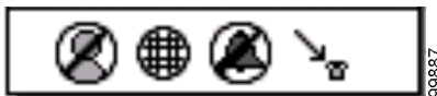
Slika 3 LCD prikaz prozora statusa na Cisco Unified IP telefonu (7940G ili 7960G) u načinu proxy linije
