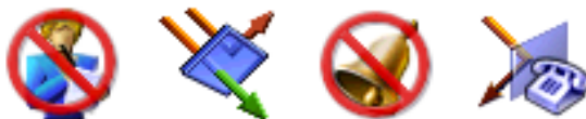
圖 4 在代理線路模式下，Cisco Unified IP Phone (7941G、7941G-GE、7961G、7961G-GE、7970G、7971G-GE) 狀態視窗的 LCD 顯示
