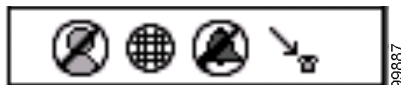
图 3 代理线路模式下 Cisco Unified IP 电话（7940G 或 7960G）状态窗口的 LCD 显示屏
