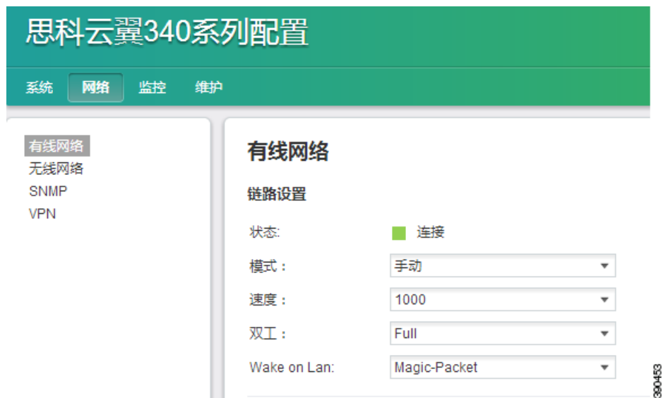
图 3-12 Wake on Lan 设置
