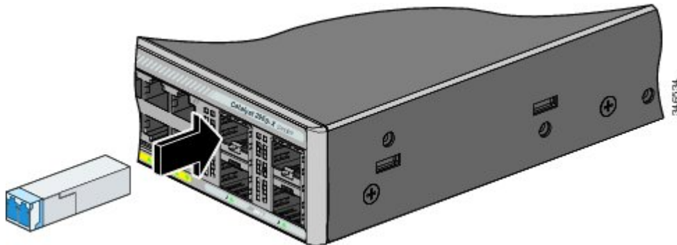
Figure 27: Installation d'un module SFP
