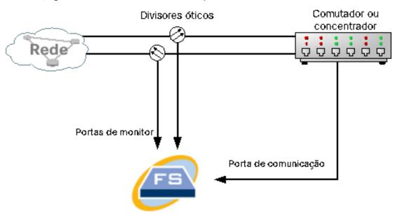
Se existir uma ligação de fibra ótica entre as redes monitorizadas, o Sensor de fluxo é ligado a dois divisores óticos. A porta de gestão é ligada ao switch da rede monitorizada ou a outro switch ou hub.
