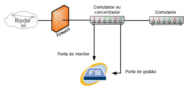
Para monitorizar o tráfego dentro da sua firewall com uma TAP, insira a TAP ou o divisor ótico entre a firewall e o switch ou hub principal. A configuração da TAP é apresentada abaixo.
