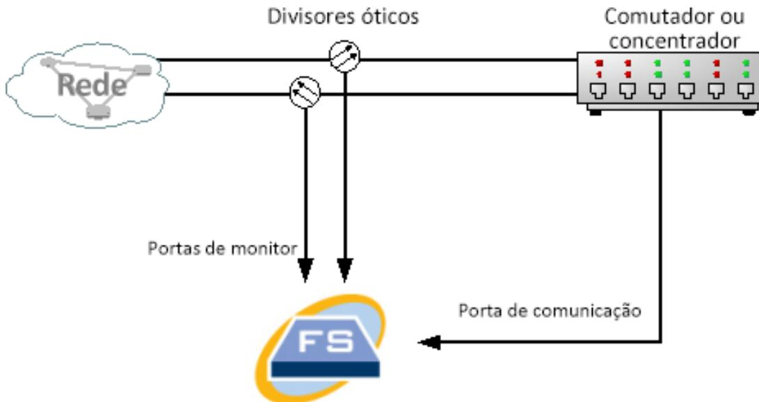
Se existir uma ligação de fibra ótica entre as redes monitorizadas, o Sensor de fluxo é ligado a dois divisores óticos. A porta de gestão é ligada ao switch da rede monitorizada ou a outro switch ou hub.
