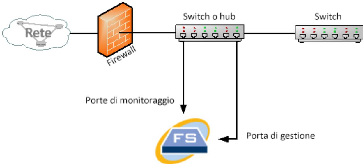
Per monitorare il traffico all'interno del firewall con una TAP, inserire la TAP o lo splitter ottico tra il firewall e lo switch principale o hub. Di seguito viene illustrata una configurazione con una TAP.
