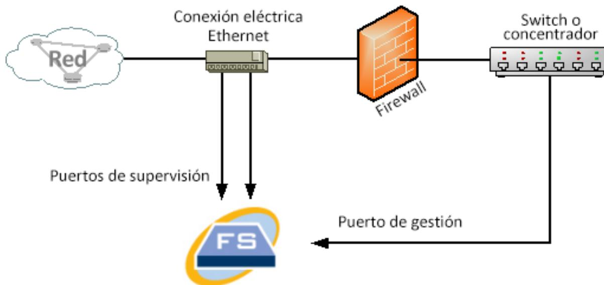
Si su firewall está realizando una traducción de direcciones de red (NAT) solo puede ver las direcciones que se encuentran en el firewall.
