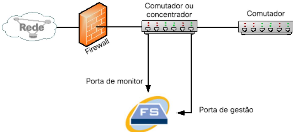
Para monitorizar o tráfego dentro da sua firewall com uma TAP, insira a TAP ou o divisor ótico entre a firewall e o switch ou hub principal. A configuração da TAP é apresentada abaixo.
