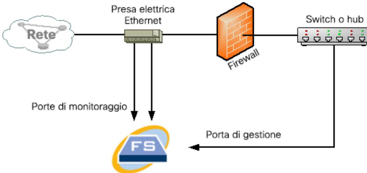
Se il firewall esegue la conversione degli indirizzi di rete, o NAT (Network Address Translation), è possibile osservare solo gli indirizzi presenti sul firewall.
