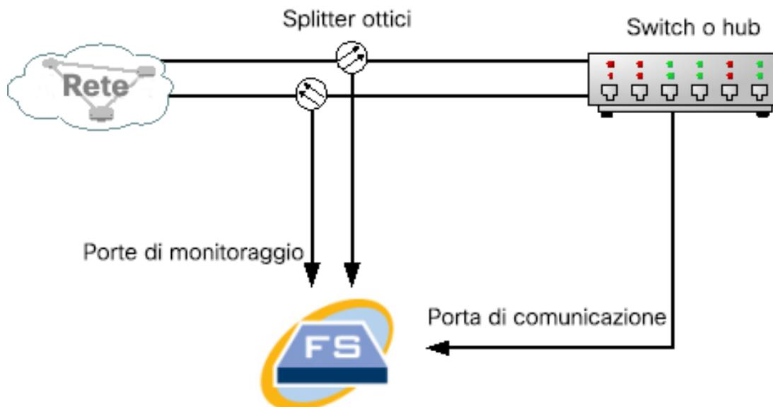
Se la connessione tra le reti monitorate è una connessione ottica, il Flow Sensor è connesso a due splitter ottici. La porta di gestione è connessa allo switch della rete monitorata o a un altro switch o hub.
