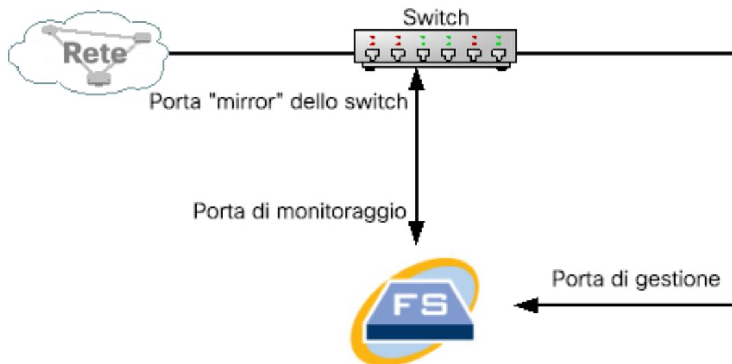
In questa configurazione, è necessario configurare una porta dello switch (denominata anche porta di mirroring) per ripetere tutto il traffico da e verso l'host di interesse alla porta di mirroring. La porta di monitoraggio 1 del Flow Sensor deve essere connessa a questa porta di mirroring. In questo modo il Flow Sensor può monitorare il traffico da e verso la rete di interesse e altre reti. In questo caso, una rete può essere composta da alcuni o tutti gli host collegati allo switch.
