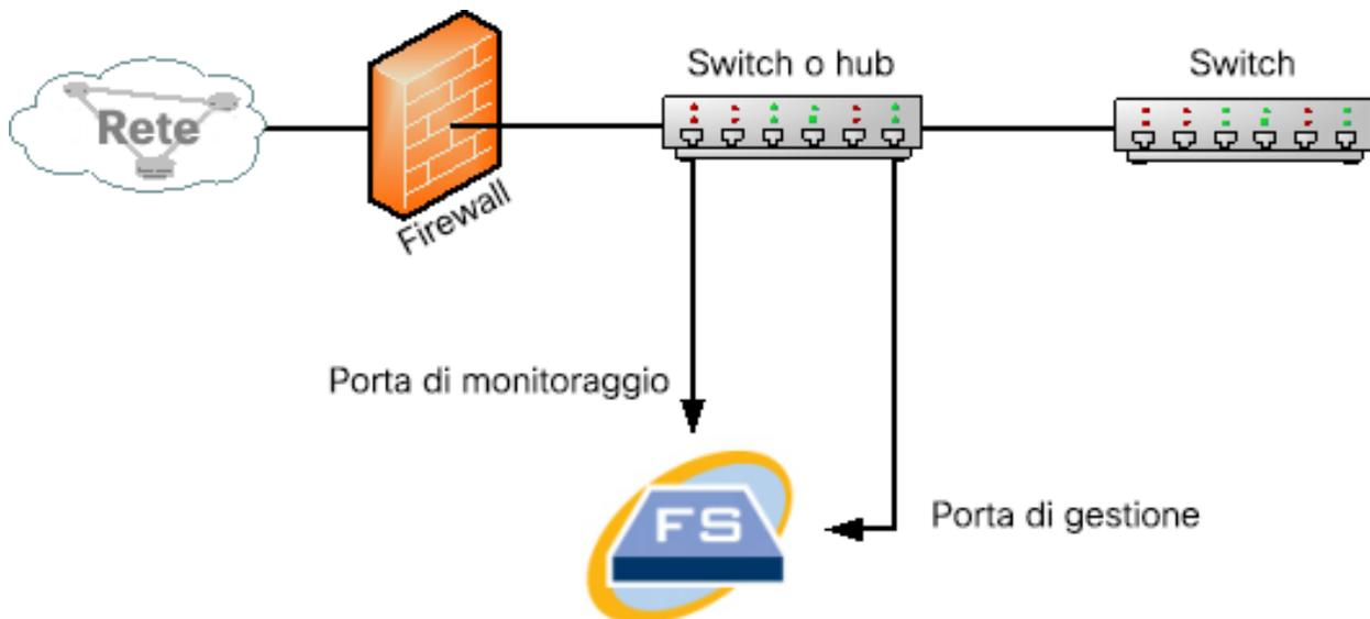
Per monitorare il traffico all'interno del firewall con una porta TAP, inserire la TAP o lo splitter ottico tra il firewall e lo switch principale o hub. Di seguito viene illustrata una configurazione con una TAP.
