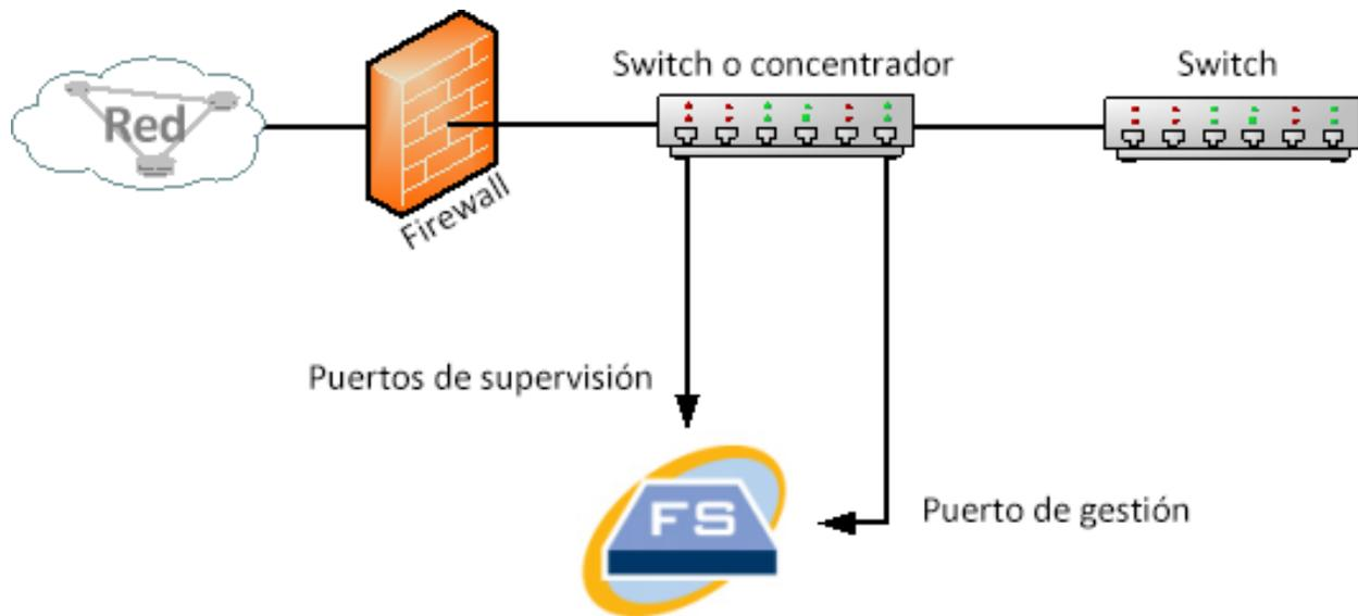
Para supervisar el tráfico dentro de su firewall usando un TAP, inserte el TAP o el divisor óptico entre su firewall y el switch principal o hub. A continuación, se muestra una configuración de TAP.
