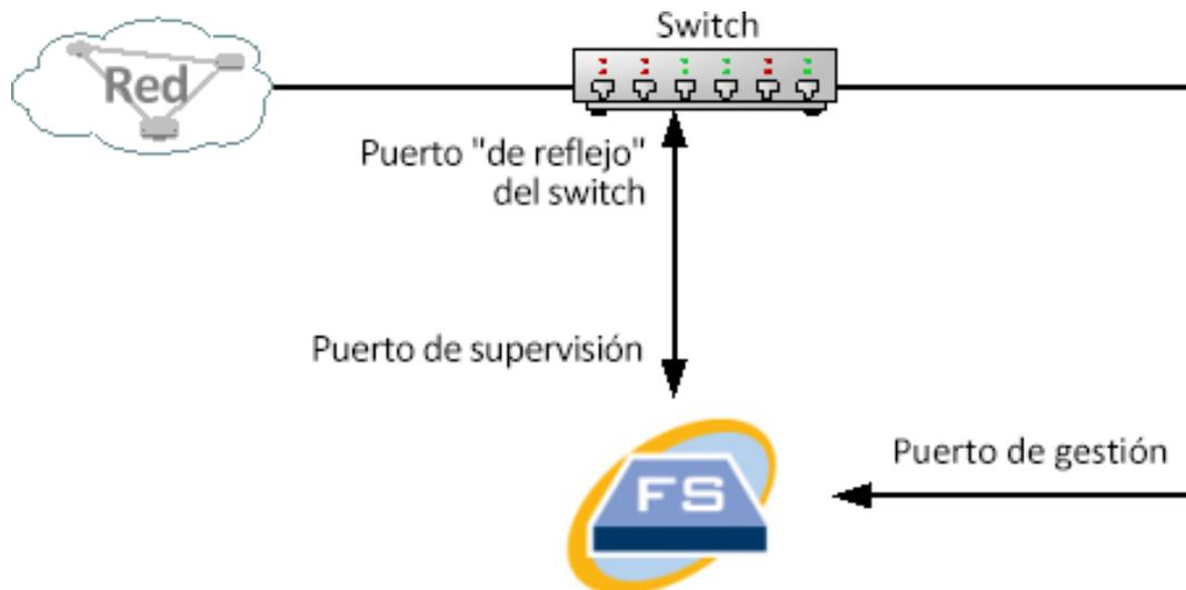
En esta configuración, debe configurar un puerto de switch (también llamado puerto de reflejo) para repetir todo el tráfico de entrada y de salida del host de interés para el puerto de reflejo. El puerto 1 de supervisión del sensor de flujo se debe conectar a este puerto de reflejo. Esto permite que el sensor de flujo supervise el tráfico de entrada y de salida de la red de interés y a otras redes. En este caso, una red podría estar constituida por algunos o todos los hosts conectados al switch.
