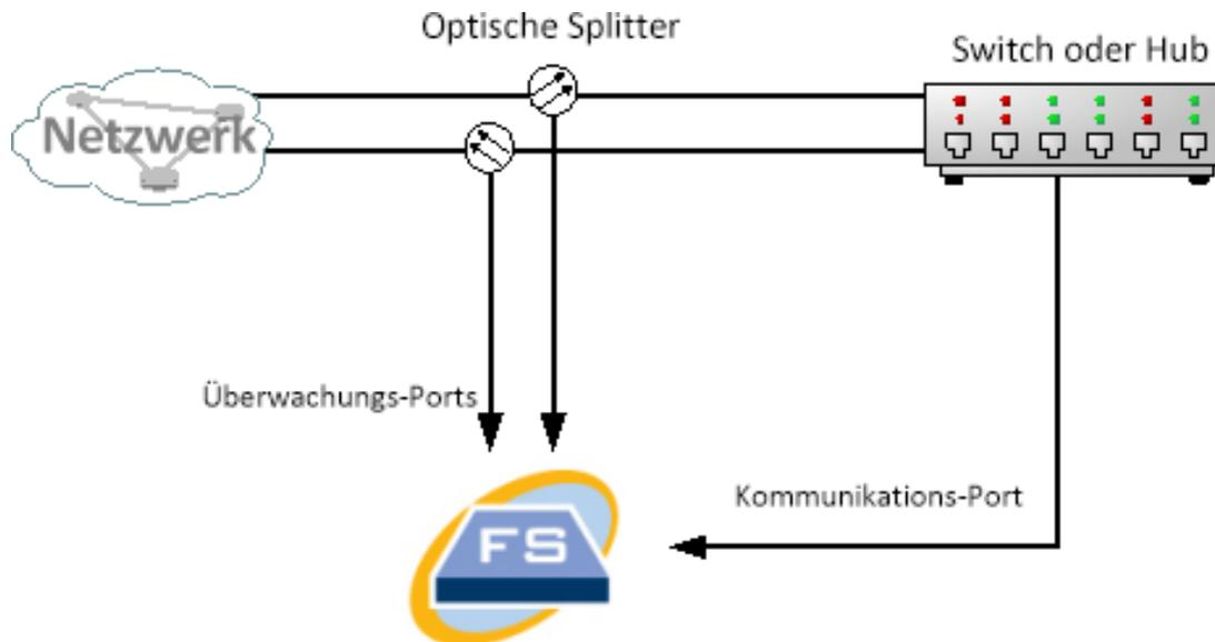
Wenn die Verbindung zwischen den überwachten Netzwerken eine optische Verbindung ist, wird der Flow Sensor mit zwei optischen Splittlern verbunden. Der Management-Port ist entweder mit dem Switch des überwachten Netzwerks oder mit einem anderen Switch oder Hub verbunden.
