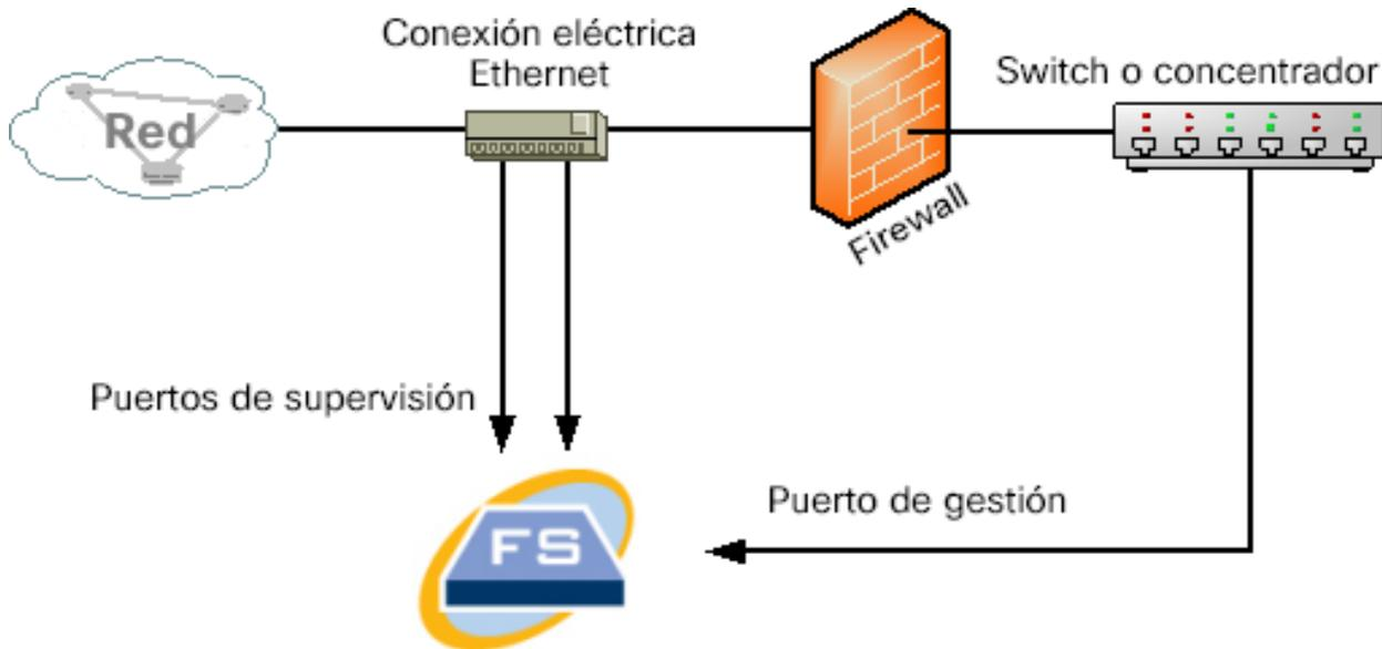
Si su firewall está realizando una traducción de direcciones de red (NAT) solo puede ver las direcciones que se encuentren en el firewall.
