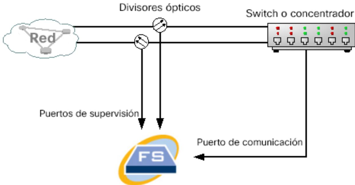
Si la conexión entre las redes supervisadas es una conexión opcional, el sensor de flujo se conecta a dos divisores ópticos. El puerto de gestión se conecta al switch de la red supervisada o a otro switch o hub.
