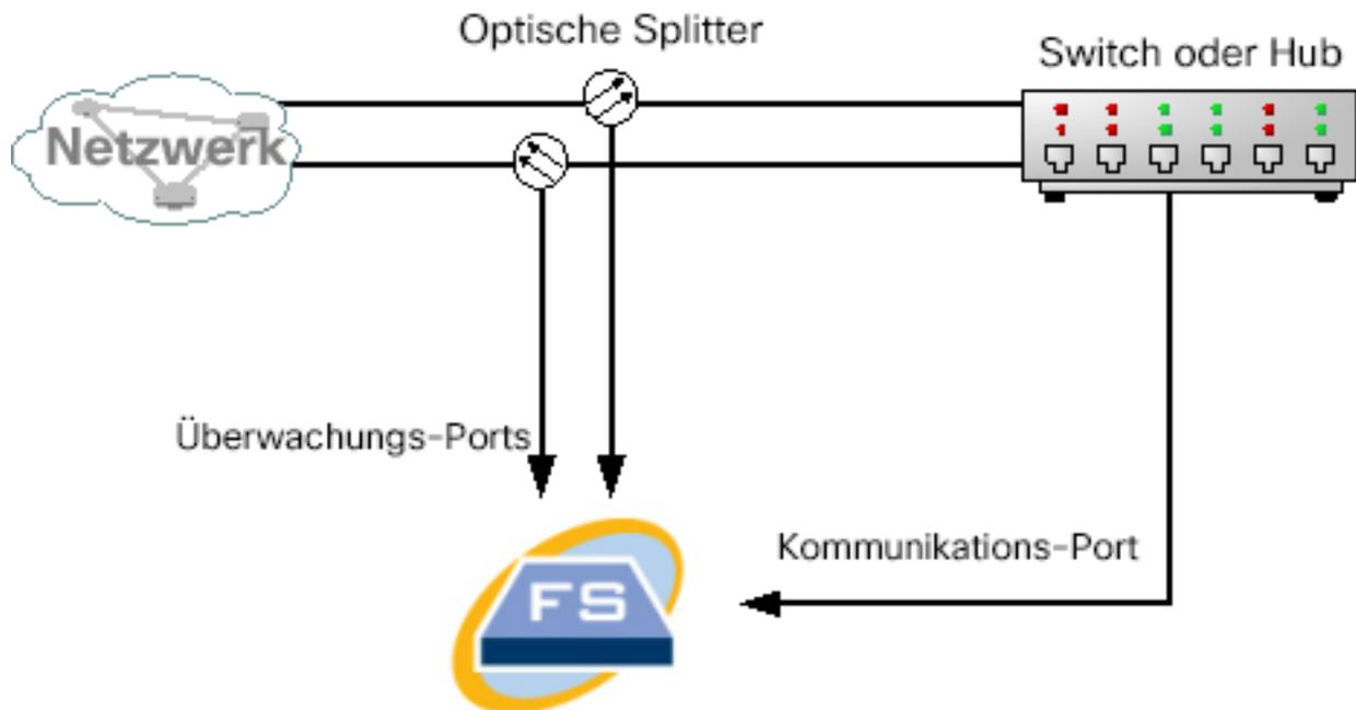
Wenn die Verbindung zwischen den überwachten Netzwerken eine optische Verbindung ist, wird der Flow Sensor mit zwei optischen Splittern verbunden. Der Management-Port ist entweder mit dem Switch des überwachten Netzwerks oder mit einem anderen Switch oder Hub verbunden.
