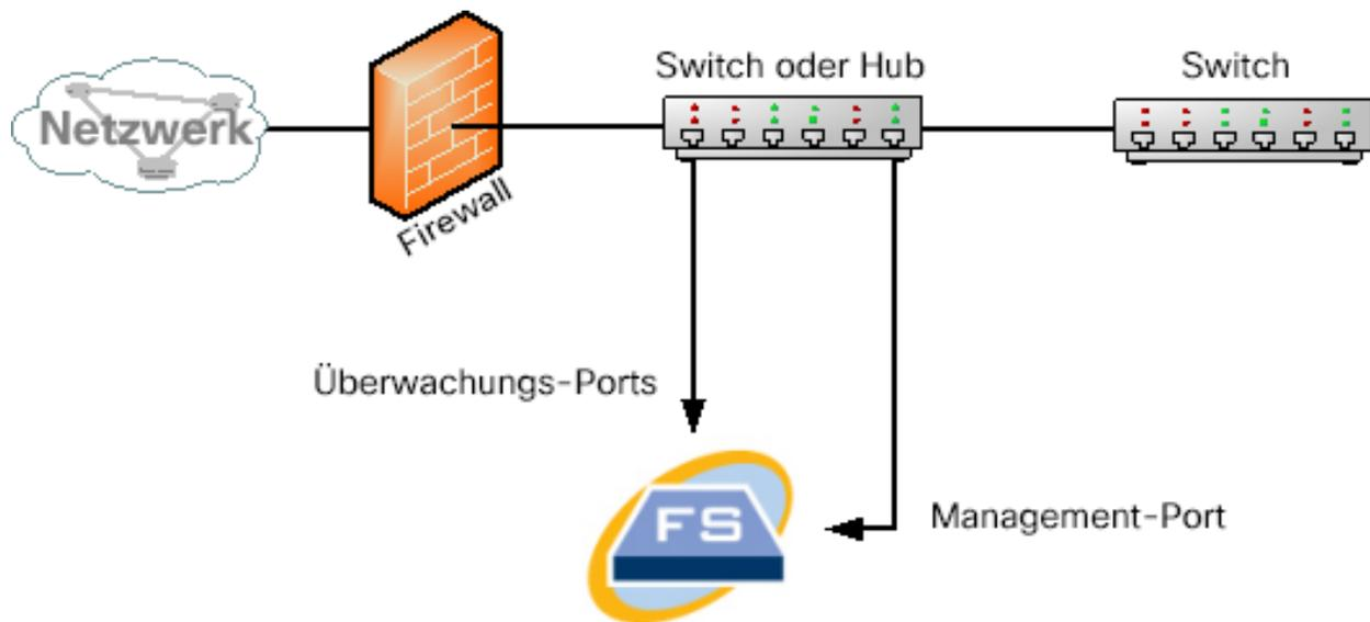
Um den Datenverkehr innerhalb Ihrer Firewall mit Hilfe eines TAP zu überwachen, platzieren Sie den TAP oder den optischen Splitter zwischen Ihrer Firewall und dem Haupt-Switch oder -Hub. Eine TAP-Konfiguration ist unten dargestellt..
