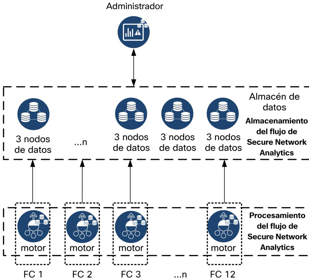
El almacén de datos proporciona un repositorio central para almacenar la telemetría de su red, recogida por los recopiladores de flujo. El almacén de datos se compone de un clúster de nodos de datos, cada uno con una parte de sus datos, y una copia de
