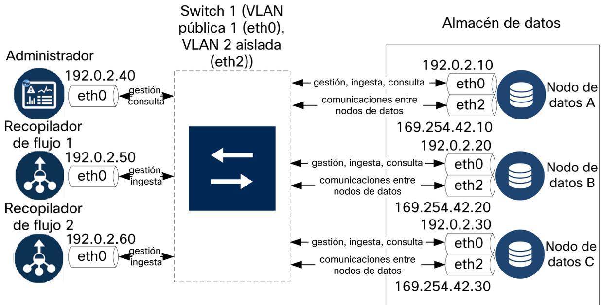
El clúster del almacén de datos requiere un latido continuo entre los nodos dentro de la VLAN aislada. Sin este latido, los nodos de datos podrían desconectarse, lo que aumenta el riesgo de que el almacén de datos se desconecte.
