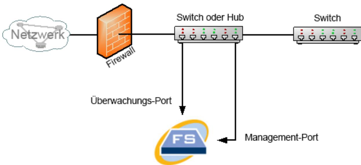
Um den Datenverkehr innerhalb Ihrer Firewall mit Hilfe eines TAP zu überwachen, platzieren Sie den TAP oder den optischen Splitter zwischen Ihre Firewall und dem Haupt-Switch oder -Hub. Eine TAP-Konfiguration ist unten dargestellt..
