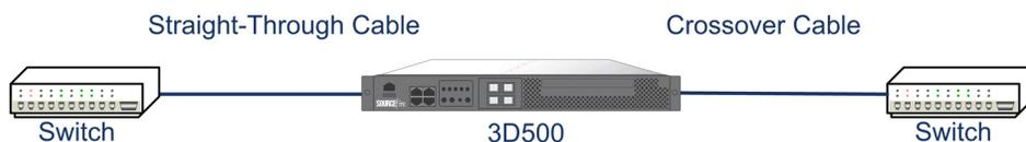
对于使用交叉连接旁路的受管设备，请像未部署设备一样正常连接设备。这种连接在设备断电的情况下应该仍能够正常工作。大多数情况下，应使用两根直通电缆将设备连接至两个终端。
