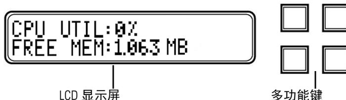
在空闲显示模式中，该面板交替显示 CPU 利用率和可用内存以及机箱序列号。您可访问网络配置、系统状态和信息模式，只需中断空闲显示模式以显示 LCD 面板的主菜单。
